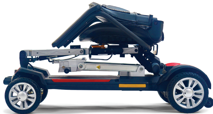
La barre et le cadre du siège autobloquant se replient pour un profil compact
